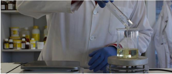
**Paso 1.** Medir los aceites con una probeta y verter en un vaso de precipitados.
