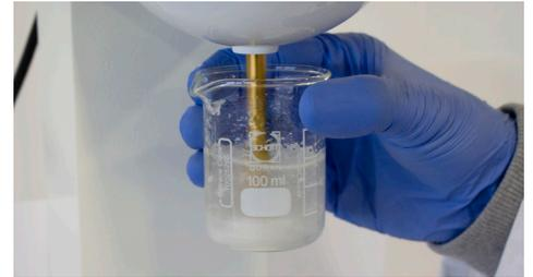
**Paso 6.** Calentar la mezcla en placa calefactora, bajo agitación suave. Retirar cuando empiece a hervir y continuar agitando.
